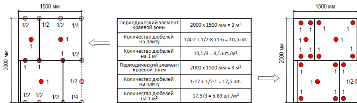
Рис. 5. Расчет количества дюбелей на 1 м 2 краевой зоны для схем "Т- установка" и "Центр/углы - установка" для ППС
