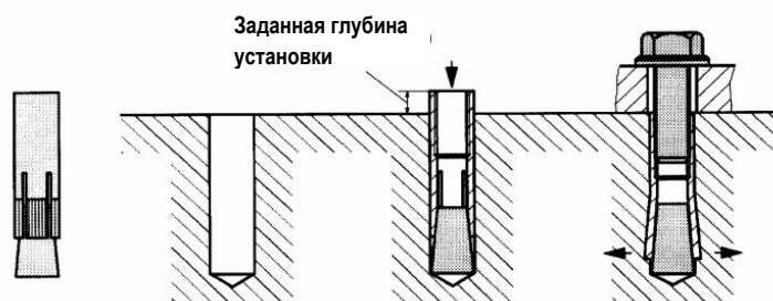
в) Тип анкера с перемещаемой вниз втулкой; сверление дрелью с фиксатором
