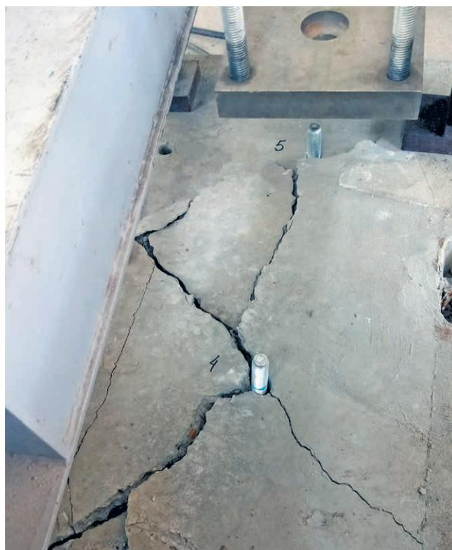
Рисунок 2 — Разрушение бетона основания в ходе испытания механического анкера
